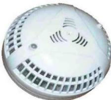
**Автономный пожарный извещатель "ИП-212-72 М" автономное питание от 4-х элементов "AAA", встроенный звуковой сигнал при появлении дыма.**
